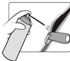
O zíper deve abrir e fechar macio com o cursor deslizando suavemente. Se houver dificuldade em movimentar o cursor deve ser aplicado parafina ou "spray" lubrificante nos dentes, para diminuir o atrito entre os componentes. Com alguma movimentação do zíper, você vai notar a diferença.
